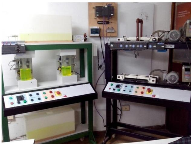
Fig. 2. Modelos de celdas de trabajo
